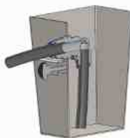
Przekrój: Rubi z ochroną przed przepełnieniem (funkcja dekantacji)
